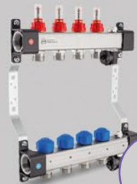
Jakotukki virtausmittareilla, 2,5 l/min tai 5 l/min (max) käyttölaitteellisilla venttiileillä ja ilmanerottimella, - sarja UFST tai UFST max
